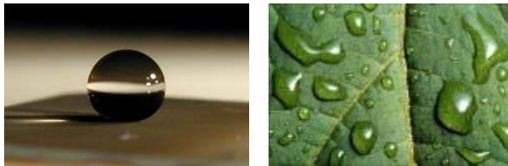
Figura 2. Ejemplos de superficies que no se mojan (gota redonda) y que sí (gota achatada).
